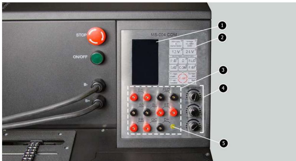
Рисунок 3 – Пульт управления стендом
