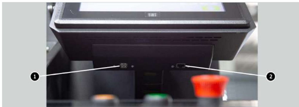
Rysunek 4. Lokalizacja złączy USB i LAN
