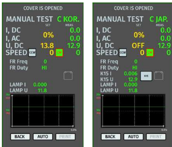
Рисунок 8. Меню режима проверки генератора типа C KOR и C JAP.
