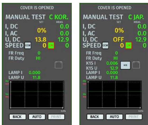
Rysunek 8. Menu trybu badania alternatora typu C KOR i C JAP.
