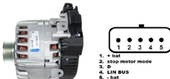
Rysunek 25. Alternator Valeo IST60C017 i oznaczenie terminali w złączu
