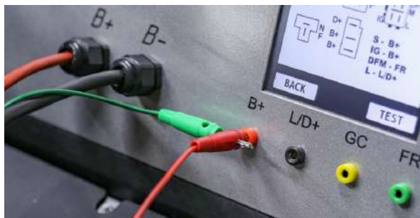
Rysunek 24. Podłączenie dwóch przewodów do wyprowadzenia diagnostycznego stanowiska
