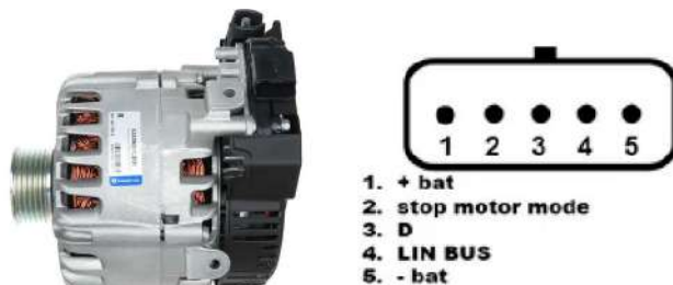
Рисунок 25. Генератор Valeo IST60C017 и обозначение терминалов в разъёме
