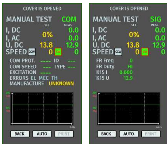
Рисунок 10. Меню режиму перевірки генератора типів COM і SIG
