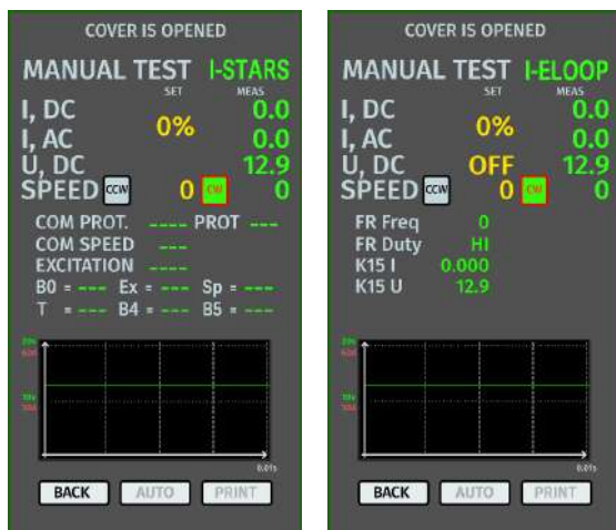
Rysunek 11. Menu trybu badania alternatora typu I-STARS i I-ELOOP
