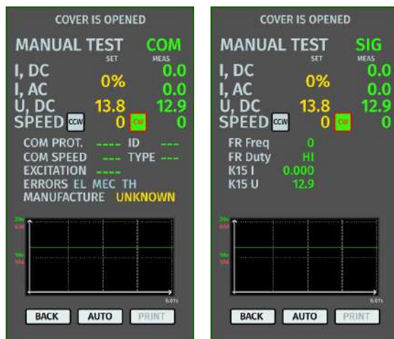
Rysunek 10. Menu trybu badania alternatora typu COM i SIG
