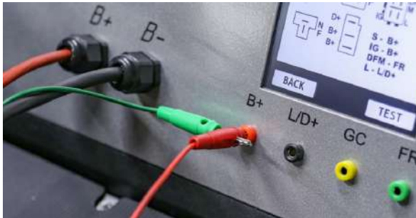
Рисунок 24. Підключення двох дротів до діагностичного виводу стенда
