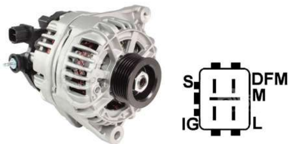
Rysunek 21. Alternator Toyota 2706020230 i oznaczenie terminali w złączu
