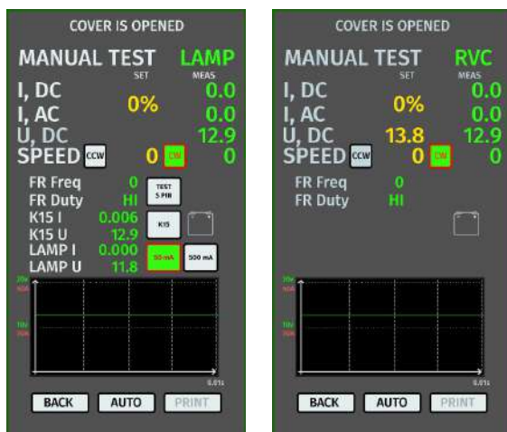
Rysunek 7. Menu trybu badania alternatora typu LAMP i RVC
