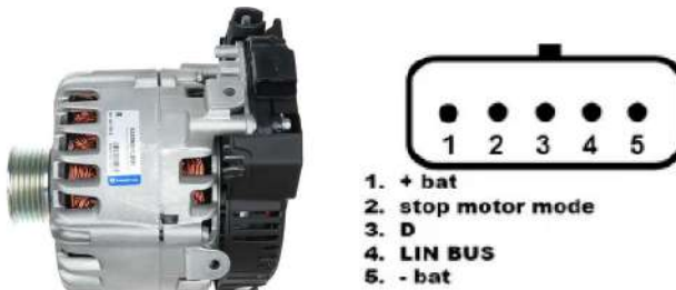
Рисунок 25. Генератор Valeo IST60C017 і позначення терміналів у роз'ємі
