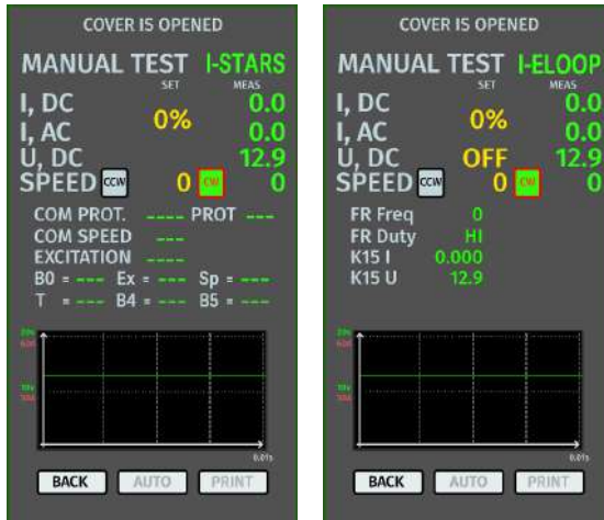
Рисунок 11. Меню режиму перевірки генератора типів I-STARS і I-ELOOP
