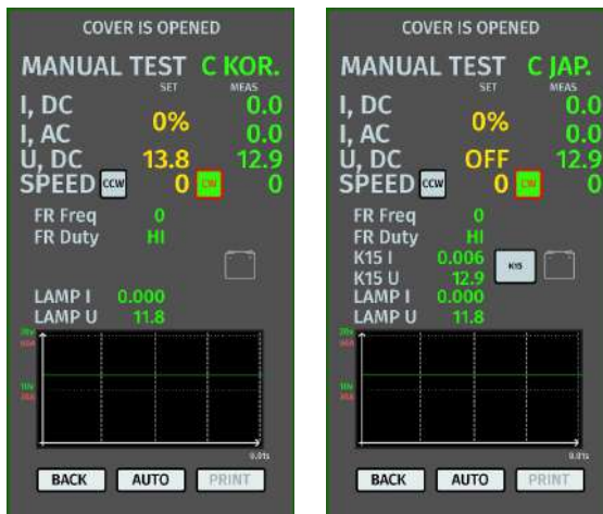
Рисунок 8. Меню режиму перевірки генератора типу C KOR і C JAP
