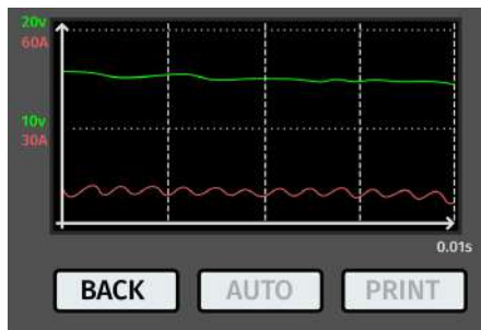
Рисунок 12. Графическое отображение измеряемого напряжения и тока проверяемого генератора
