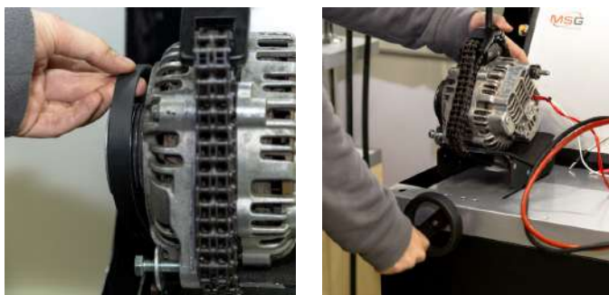
Rysunek 16. Montaż pasa na kole pasowym alternatora
