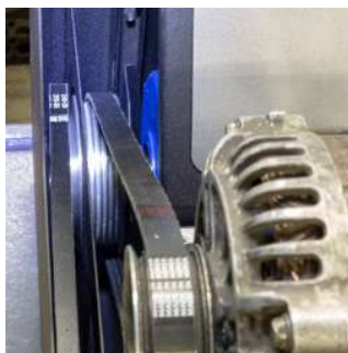
Rysunek 14. Prawidłowe ustawienie pasa napędowego alternatora
