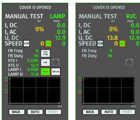
Figura 7. Menú del modo de prueba de alternadores tipo LAMP y RVC
