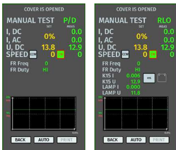
Rysunek 9. Menu trybu badania alternatora typu P/D i RLO
