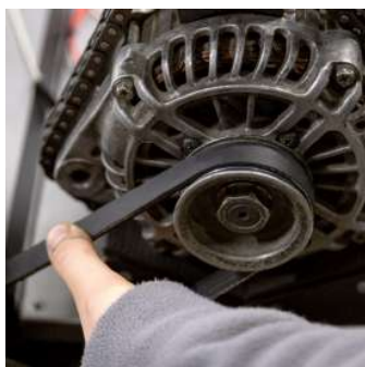
Рисунок 17. Проверка натяжения ремня генератора
