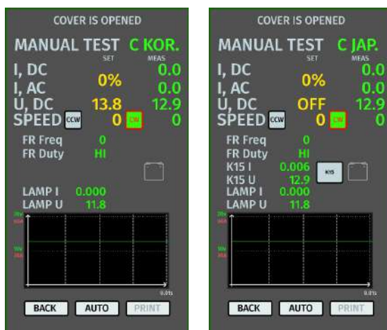
Figura 7. Menú del modo de prueba de alternadores tipo LAMP y RVC
