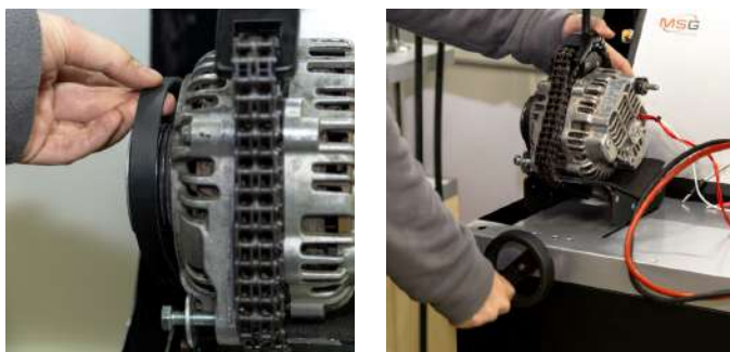
Рисунок 16. Установка ремня на шкив генератора
