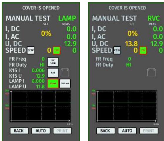
Рисунок 7. Меню режима проверки генератора типа LAMP и RVC
