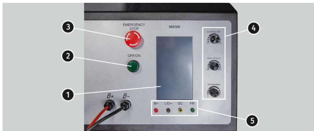
Figura 2. Panel de control del banco de pruebas
