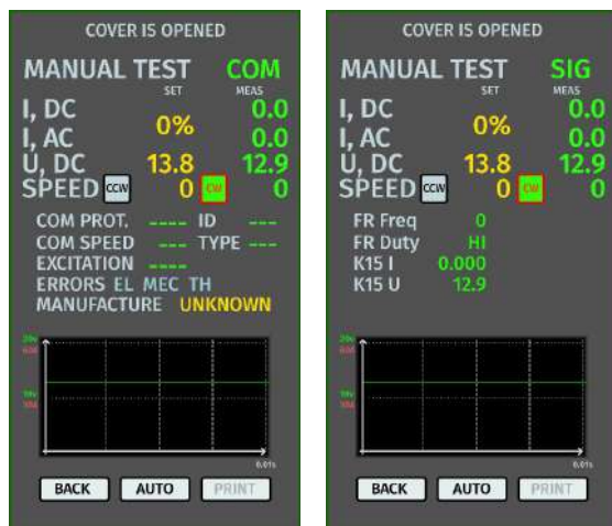
Рисунок 10. Меню режима проверки генератора типов COM и SIG
