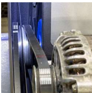
Figura 14. Cómo colocar correctamente la correa de transmisión del alternador
