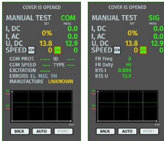
Figura 10. Menú del modo de prueba de alternadores tipo COM y SIG
