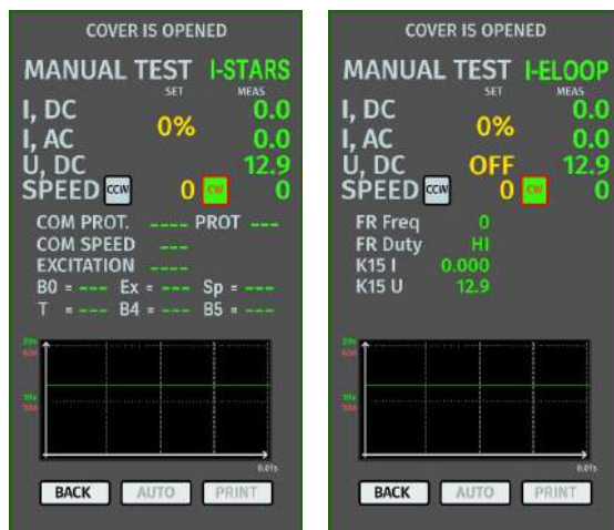
Figura 11. Menú del modo de prueba de alternadores tipo I-STARS e I-ELOOP
