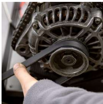
Figura 17. Como comprobar la tensión de la correa del alternador
