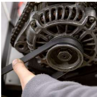
Рисунок 17. Перевірка натягу ремня генератора
