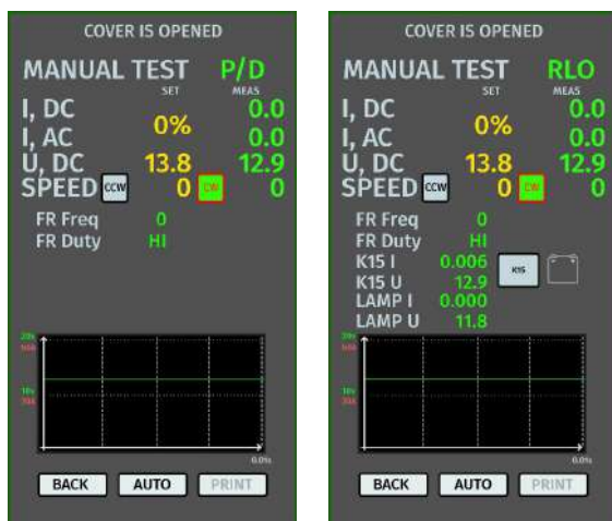
Рисунок 9. Меню режима проверки генератора типа P/D и RLO
