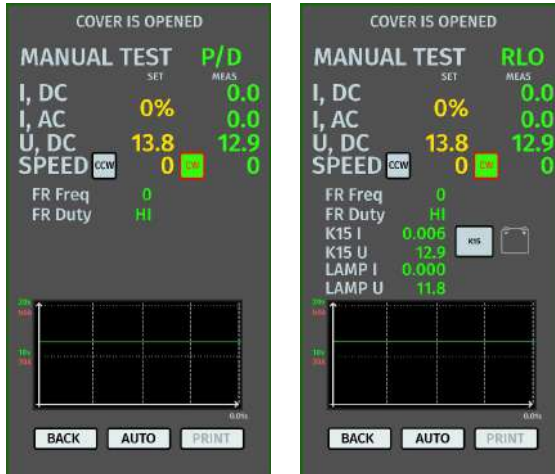
Figura 9. Menú del modo de prueba de alternadores tipo P/D y RLO
