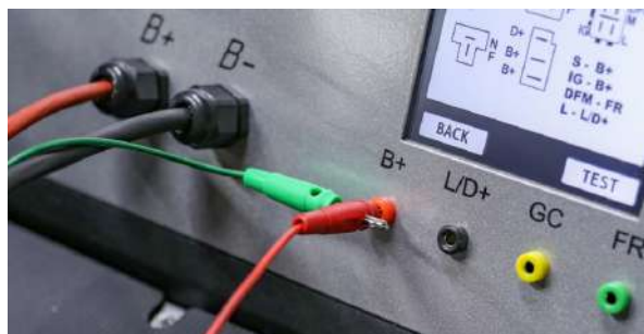
Figura 24. Conexión de dos cables a la salida de diagnóstico del banco de pruebas
