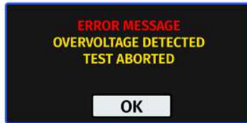
Figura 26. Mensaje en caso de activación de la protección del banco de pruebas
