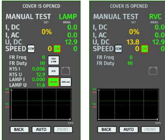
Рисунок 7. Меню режиму перевірки генератора типу LAMP і RVC
