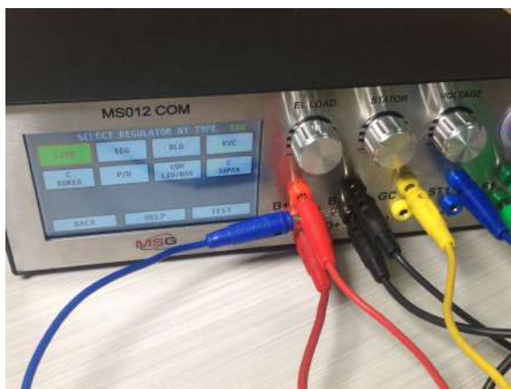
Rysunek 19. Podłączenie dodatkowego przewodu B+
