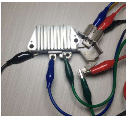
Rysunek 18. Regulator ARE6076 podłączony do wyprowadzeń testera
