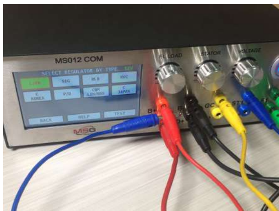
Рисунок 19. Подключение дополнительного провода В+
