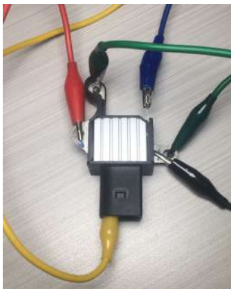
Rysunek 21. Regulator ARE6149P podłączony do wyprowadzeń testera
