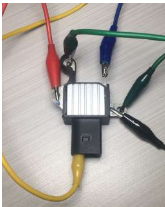
Рисунок 21. Регулятор ARE6149P, подключённый к выводам тестера
