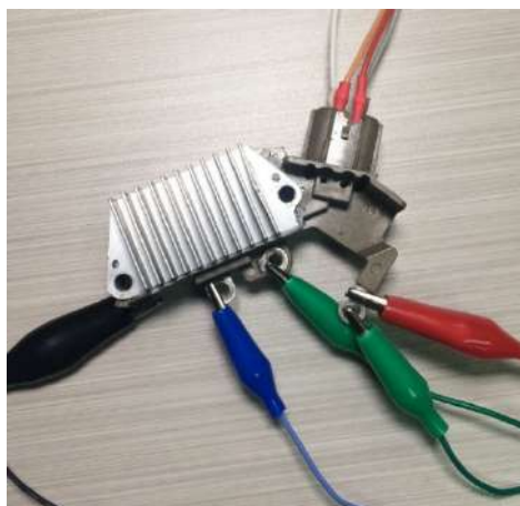
Figura 14. Esquema de conexión del regulador ARE6076 con el probador
