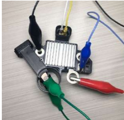
Figura 12. Esquema de conexión del regulador ARE1054 con el probador
