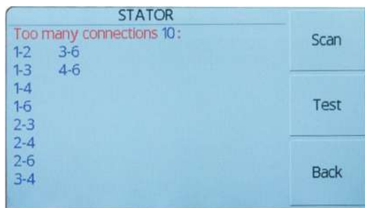
Рисунок 15. Определение подключения фаз с превышенным числом возможных коммутаций
