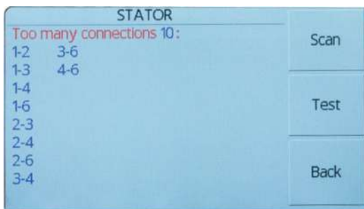
Rysunek 15. Określenia podłączenia faz z przekroczoną liczbą możliwych komutacji
