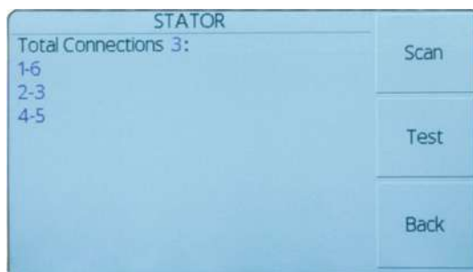
Рисунок 14. Определение подключения фаз в статорной обмотке с отдельными фазами
